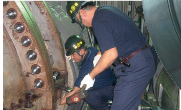
Aflojado de tornillos de carcasa (Apriete por Torsión).
